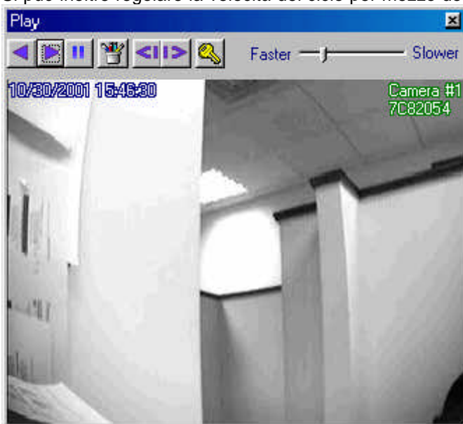
Figura 14: Player che mostra un'immagine alla quale sono sovrainpressi data, ora e numero della telecamera.
